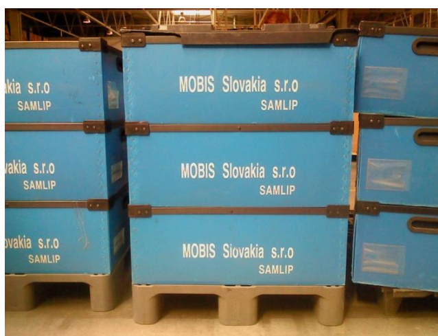
Obrázok 1: Prepravná jednotka - plastová paleta (tri vrstvy prepraviek, po dva kusy vo vrstve, plastové veko)
