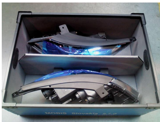
Obrázok 2: Uloženie svetlometov v prepravke
