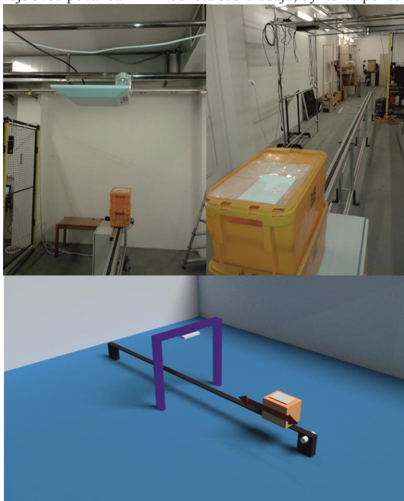
Obrázek 2. Dynamické měření RFID identifikátoru na poštovní zásilce
